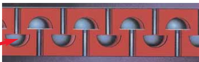
Princip vytvoření rozebiratelného spojení
